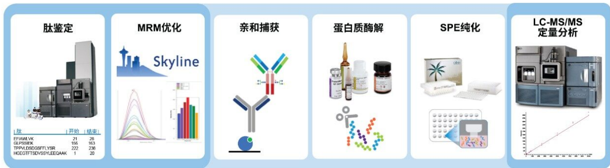
图1.利用肽图分析、MassLynx Skyline Interface (MSI) MRM优化、高灵敏度和高选择性样品前处理技术以及Xevo TQ-XS进行LC-MS/MS定量分析的定量测定方法开发工作流程
