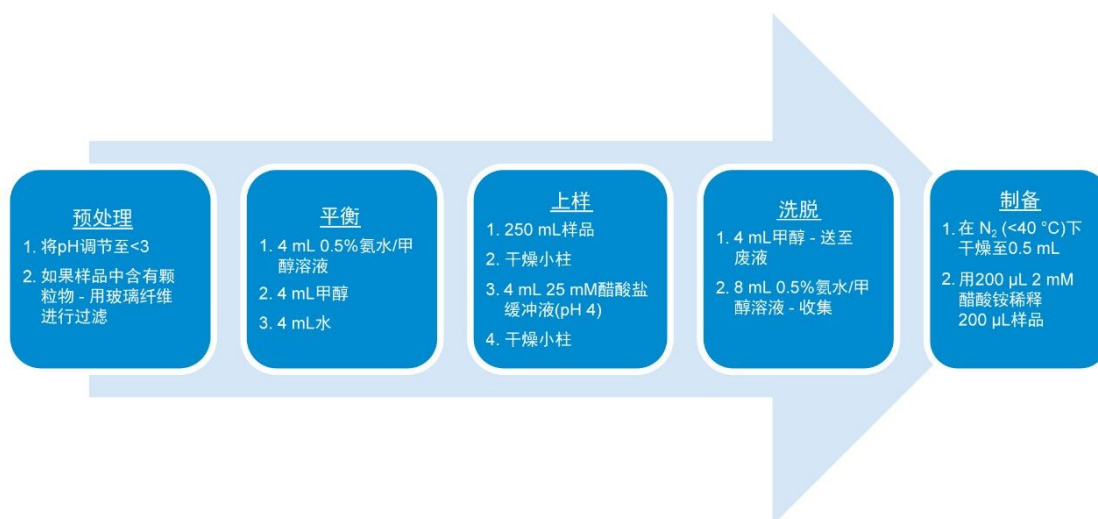
图1.完整的水样SPE样品萃取方法
